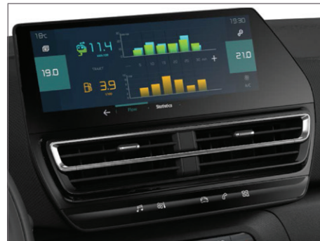
Speciální obrazovky dotykového displeje umožňující nastavení nebo konzultaci hybridního režimu
