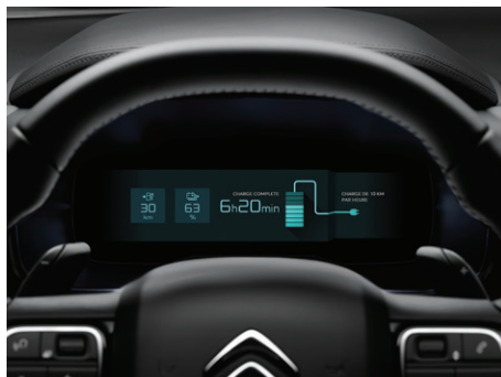
Digitální přístrojový 12,3", displej se zobrazením hybridního režimu
