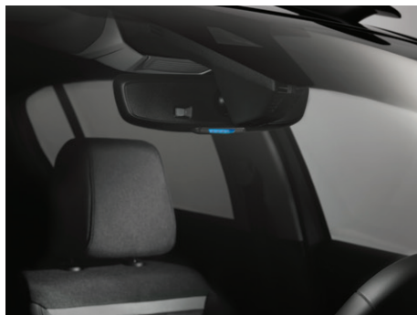
LED kontrolka signalizuje jízdu v elektrickém režimu
