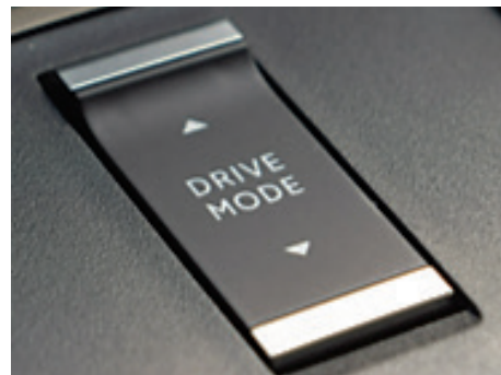
Ovládací tlačítko umožňující zvolit režim jízdy (ELEKTICKÝ, HYBRIDNÍ, SPORTOVNÍ)
